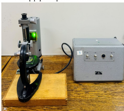
Исследование интерференции света при наблюдении колец Ньютона
