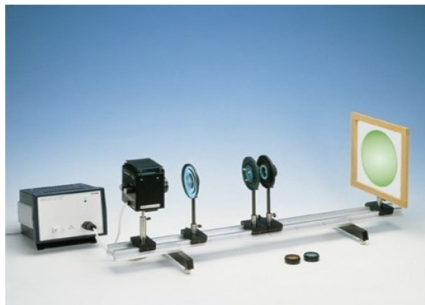
Установка «Кольца Ньютона с интерференционными фильтрами»
