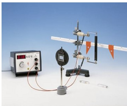
Серия Бальмера. Определение постоянной Ридберга
